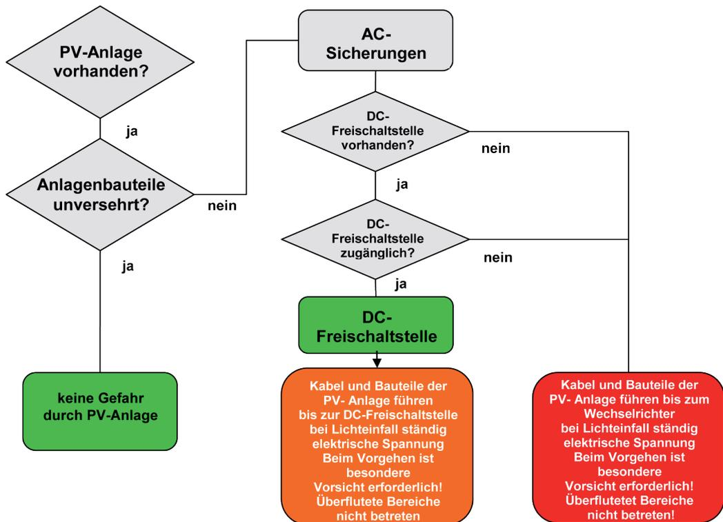
Bild 5 Schematische Vorgehensweise im Schadensfall (Quelle: Feuerwehr München)
